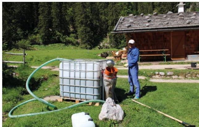
Abb. 6: Zudosierung des Flockungsmittels in den Container
