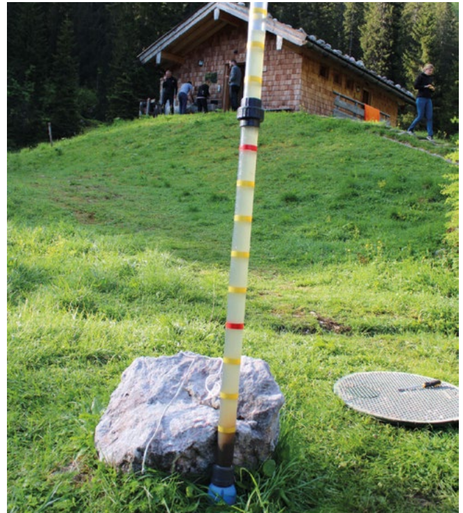
Abb. 4: Schlammspiegelmessung nach Feinschlamm entnahme – nur noch 20 cm
