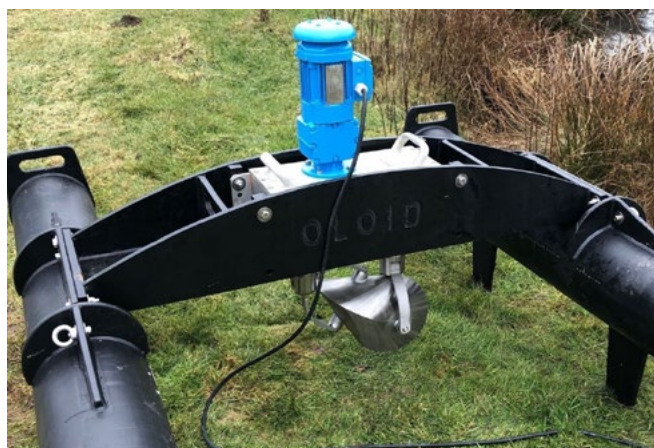
Abb. 3: Oloid Typ 400 K mit Schwimmkörper
