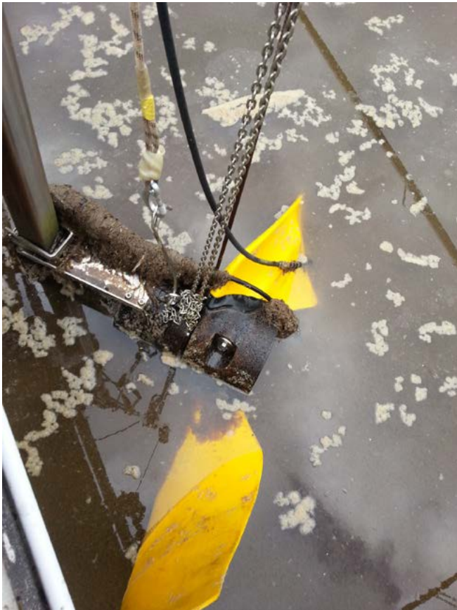
Abb. 2: Das Rührwerk macht Probleme.
