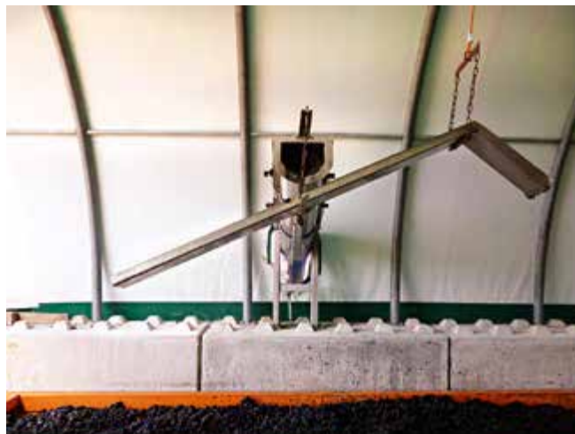
Abb. 2: Befestigung der Rinne am Austragsförderer
