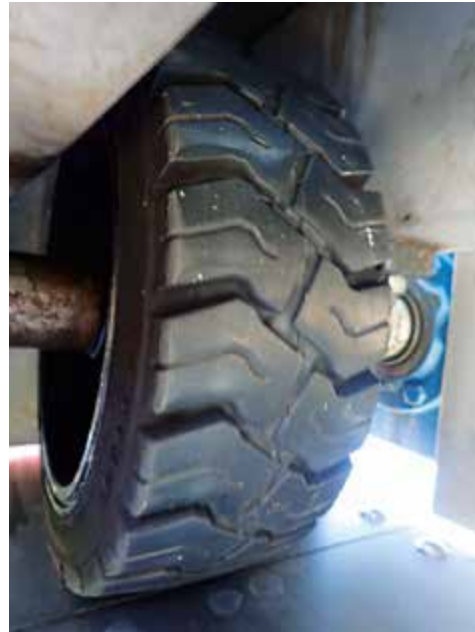
Abb. 9: Neues, breiteres und profiliertes Antriebsrad
