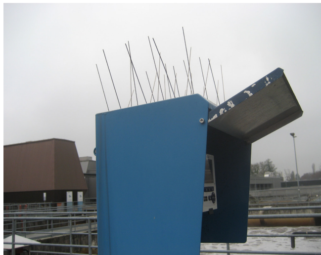
Abb. 3: Das tut schon beim Hinschauen weh – Schutzmaßnahme für das Gehäuse eines Online-Messgerätes.
