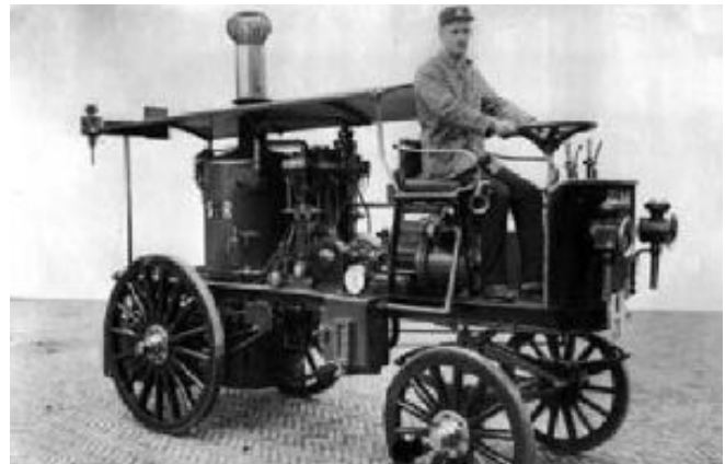
Abb. 7: Dampflokmobil mit Luftpumpe (Quelle: http://www.waterharmonica.nl/publikaties/2004_praag/Kampf_Claassen_Praag_o8.pdf )
