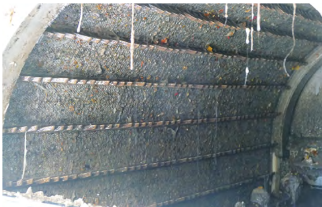
Abb. 4: Das beladene Siebband vor der Abreinigung in der Maschine
