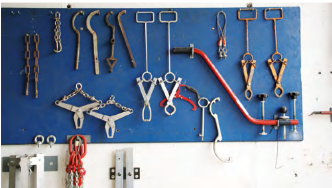
Abb. 13: Keine Kanalwartung ohne funktionsgerechtes, arbeitssicheres Werkzeug. Das fängt schon beim Kanaldeckel-Heber an.
