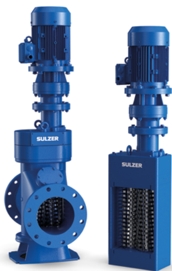
Abb. 1: Die Muffin Monster™ sind kompakte und robuste Zerkleinerer für Anwendungen im Schlamm- und Abwasserbereich. Der maximale Durchfluss liegt bei 1558 m 3 /h, der maximale Betriebsdruck bei der Gleitringdichtung beträgt 10,3 bar. Der Zulauf erfolgt über eine Rohrleitung (links) oder über einen offenen Kanal (rechts). Für größere Durchflussleistungen passt die Baureihe Channel Monster™ mit bis zu 9300 m 3 /h.
