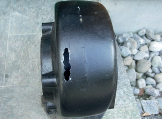
Abb. 4: Das Gehäuse einer Rücklaufschlammpumpe nach 20 Betriebsjahren
