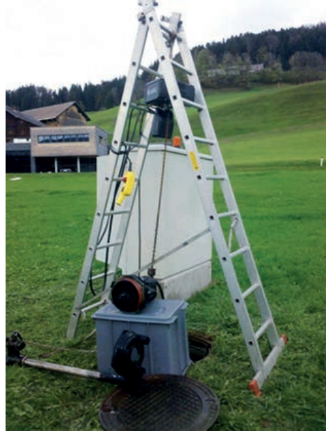
Abb. 6: Flexible und gut transportable Hebe-/Service-Einheit für dezentrale Pumpwerke
