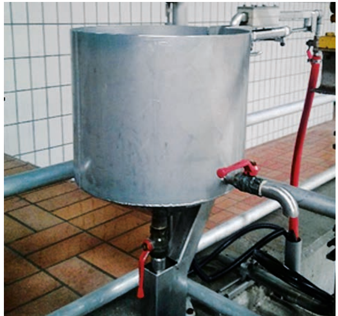
Abb. 3: Eigenbau des Schlammprobenehmers
