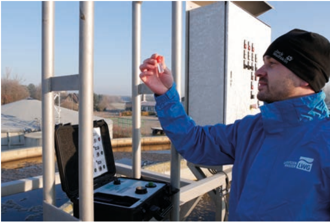
Abb. 3: Ablaufprobenahme aus dem SBR-Becken der Kläranlage Straupitz zur CSB-Bestimmung
