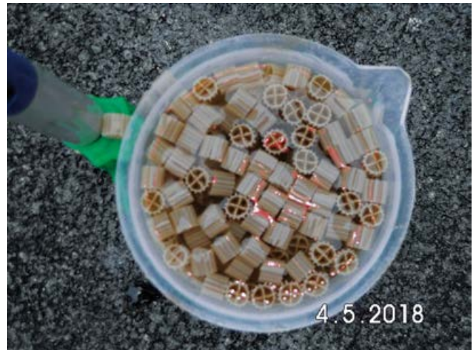
Abb. 3: Aufwuchskörper mit aktivem Biofilm aus der Containerkläranlage
